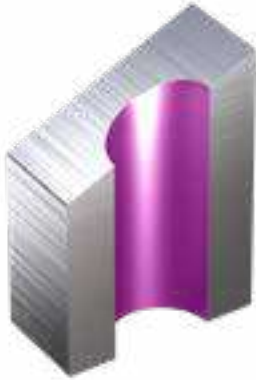
Ingresso su superficie inclinata
